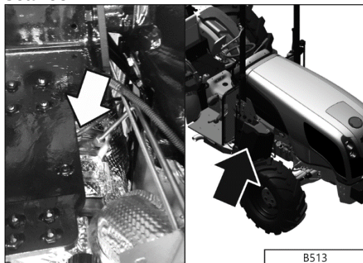
B513 - Sensore 2 temperatura gas di scarico
