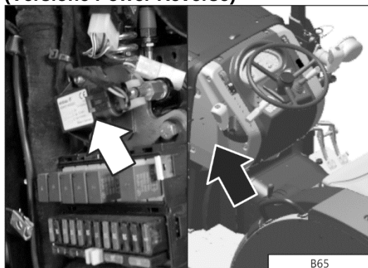
B73 - Pressostato intasamento filtro olio trasmissione (Versione Power Reverse)
